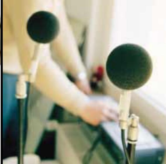
Im Schlafzimmer der Willscheids werden Mikrofone aufgestellt, um parallel zu den Körperfunktionen der Testschläfer die Geräusche aufzuzeichnen. An den Kurven lässt sich ablesen, wo Körperreaktionen auf Lärmereignisse zurückgehen.
